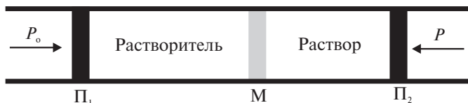
Рис. 6.4. Соотношение между осмотическим давлением раствора \pi и внешними гидродинамическими давлениями p и p_0
