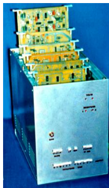
Устройство (и печатная плата) для автоматического распознавания подводных объектов
