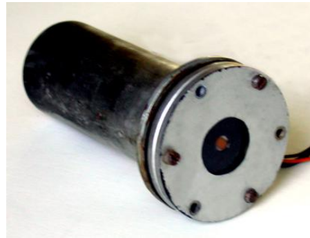
Полупроводниковый автоматический прибор для управления сигнальными огнями бакенов
